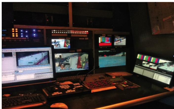
HD-replay System LGZ.replay für die Aufzeichnung und Bearbeitung der Dartfish Stromotion und Simulcam- Analyse ein. Mit diesem Analysesystem können Vergleiche und Überblendungen zwischen mehreren Sequenzen z.B. von Skifahrern realisiert werden, die dann von einem Experten live analysiert und kommentiert werden. Mit dem LGZ.replay konnten 3 abgesteckte Kamerasignale aufgezeichnet und somit jederzeit dem Dartfish-Analysesystem zugespielt werden.
