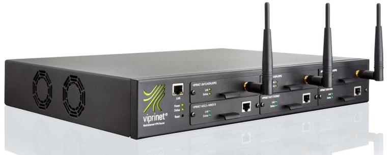
Dieser Router im 19"-Format ermöglicht die Bündelung von bis zu sechs beliebigen Internetzugängen unterschiedlicher Anbieter zu einer einzigen virtuellen Standleitung. Die maximale Bündelungskapazität liegt bei 125 MBit/s. Damit bietet der Router genügend Bandbreite für den Aufbau von Unternehmensnetzwerken unterschiedlicher Größe. Durch Hinzufügen oder Entfernen der einzelnen Hotplug Module kann das Netzwerkdesign individuell und schnell auf wechselnde Anforderungen angepasst werden.
