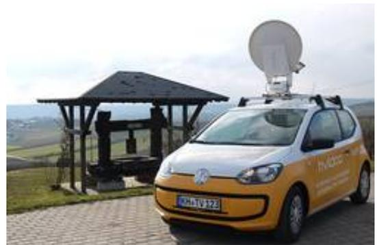
Tivido bietet in einem kleinen Fahrzeug eine gebündelte Breitbandanbindung über Satellit und Mobilfunk.
