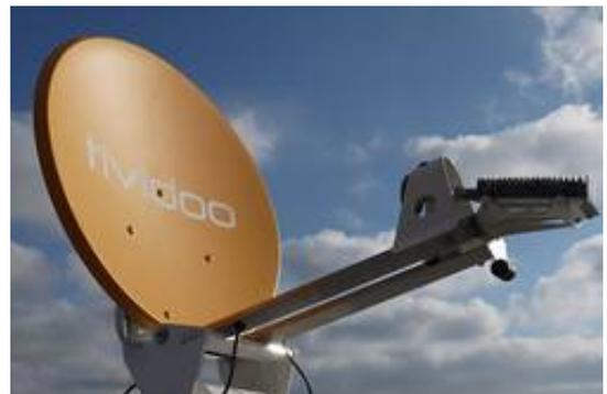
Der Anbieter zeigt das Fahrzeug auch während der CeBit. Das Auto kann sowohl als mobiler Hotspot als auch als IP-SNG für Video- und Audiostreaming genutzt werden, u.a. mit dem mobilen Multichannel VPN Router 500 von Viprinet und der selbstausrichtenden Ka-Band Antenne von Dawson Dynamic.
